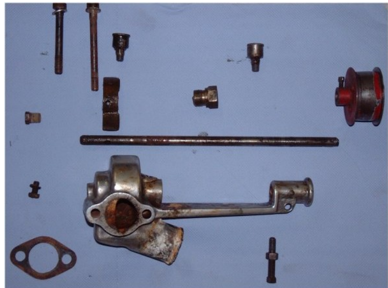
Hier sind alle Teile der Wasserpumpe nach Zerlegung zu sehen. Was fehlt ist die Graphitdichtung.
