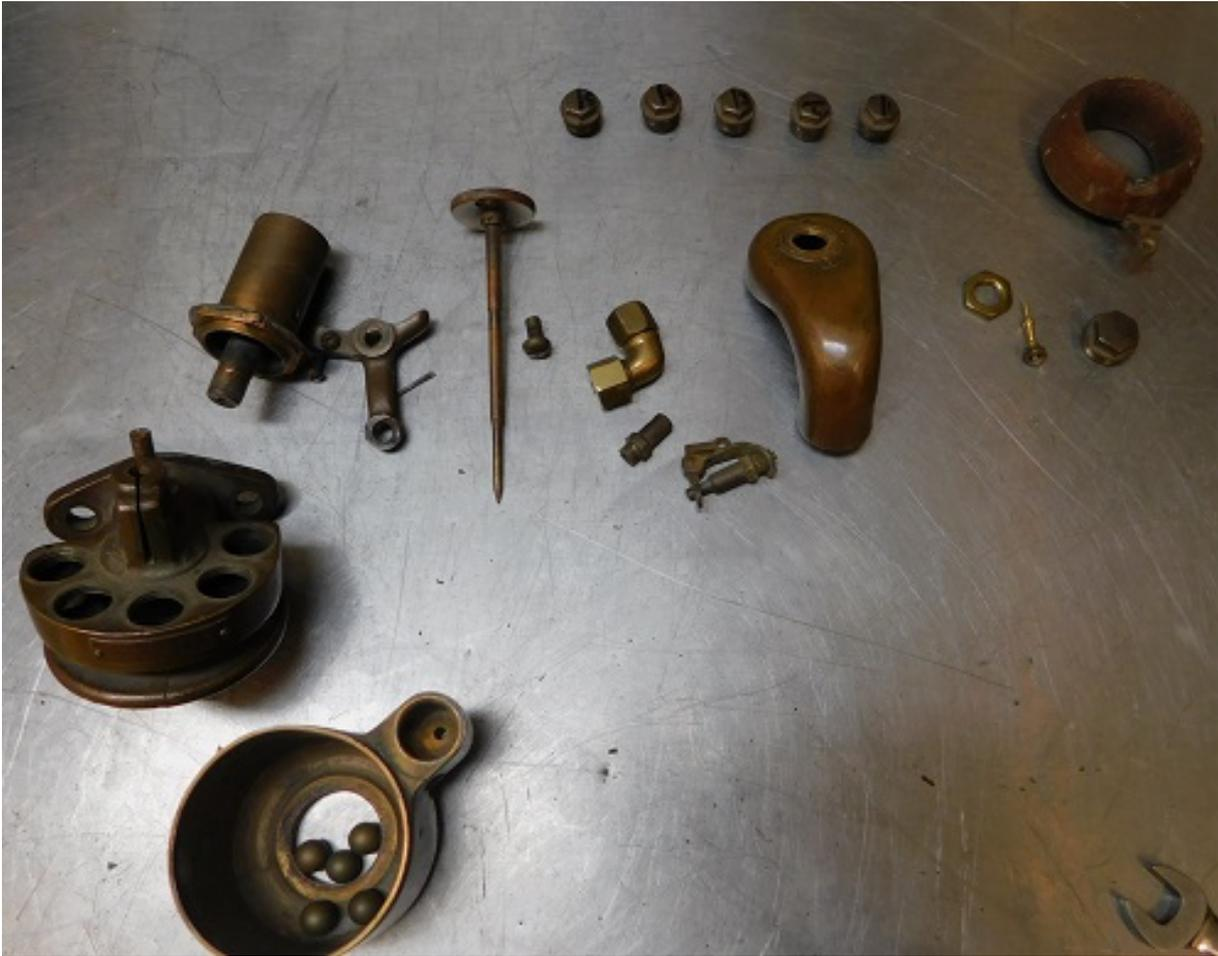
Die Hauptdüse ist innen und außen mit Kraftstoffrückständen verklebt.
