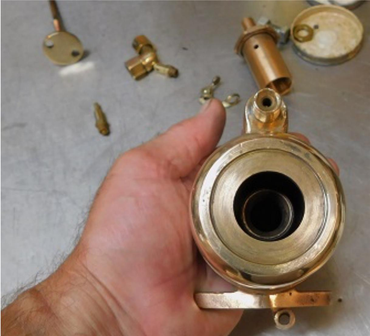
Die Schwimmerschale hat keine Dichtung an der Oberseite, sie ist passgenau auf das Vergasergehäuse zugeschnitten. Der Kraftstoffeinlass befindet sich 180 Grad vom Befestigungsflansch entfernt.
