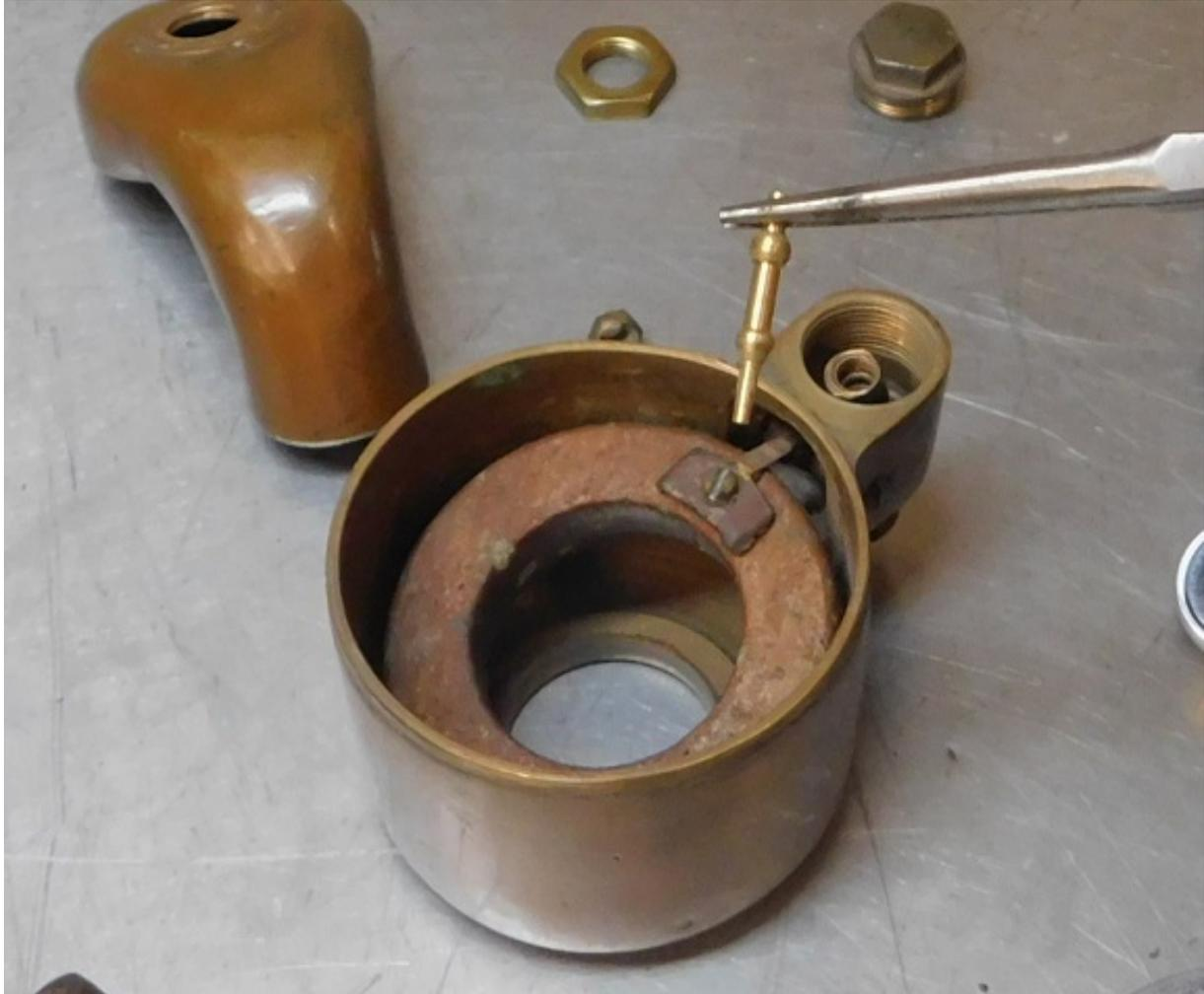
An dieser Stelle spannen wir die Vergaserschale in den Schraubstock ein, damit beim Entfernen des Schwimmerscharniers viel Druck auf den Schraubendreher ausgeübt werden kann.
