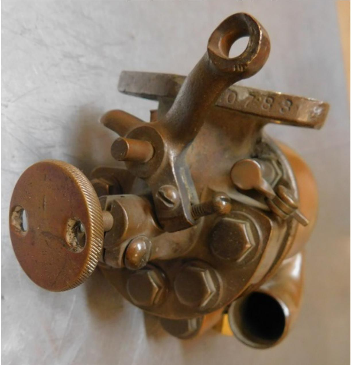
Wir beginnen mit der Demontage, indem wir die Mutter entfernen, mit der das Lufthorn an der Unterseite des Vergasers befestigt ist.
