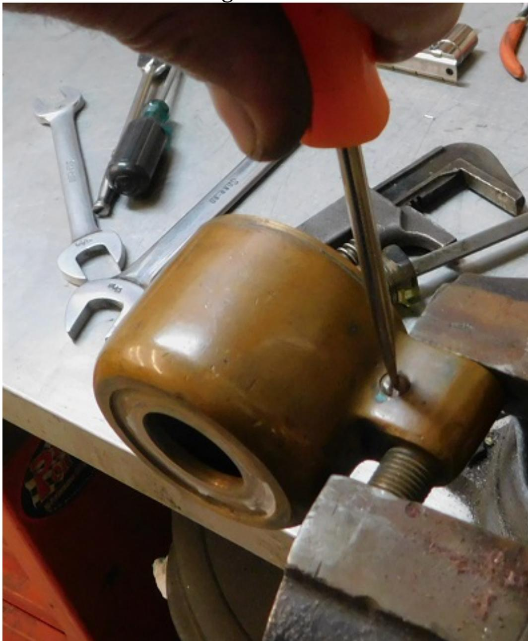
Wir lassen die Drosselklappe intakt und treiben den Stift, der den Drosselarm an der Welle befestigt, mit einem 3/32"-Durchschlag heraus.
