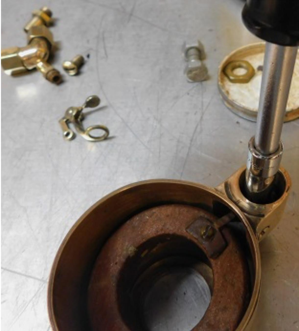
Der Scharnierstift wird eingebaut, dann wird der Stift des Kraftstoffeinlassventils eingesteckt und mit der Mutter gesichert.
