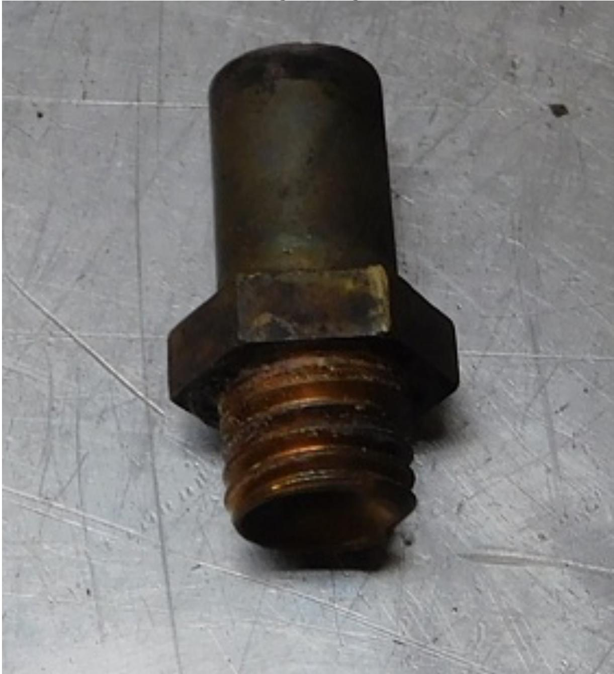
Im Laufe der letzten 100 Jahre haben Vergaserreparateure verschiedene Symbole auf jede der Kugelkappen gekratzt. Wir werden alle Markierungen abschleifen und jeden einzelnen polieren, damit sie in Ordnung bleiben.
