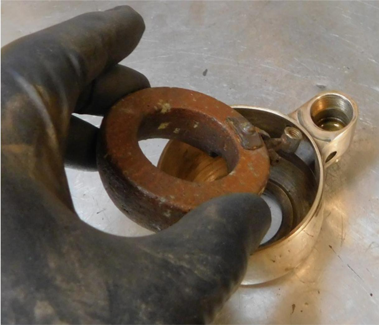
Der Originalschwimmer sieht tadellos aus. Wir werden ihn wieder verwenden. Im Handel ist ein Schwimmer aus Messing erhältlich, der sich gut eignet, wenn der Schwimmer ersetzt werden muss.
