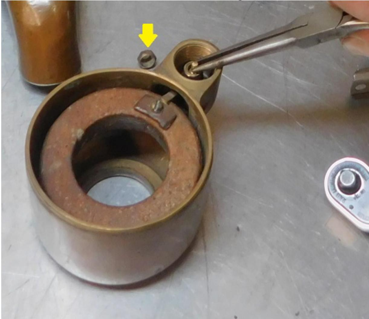
Beachten Sie, dass der Ventilschaft unten anders geformt ist als oben. Es wird nicht richtig funktionieren, wenn es verkehrt herum eingebaut wird.
