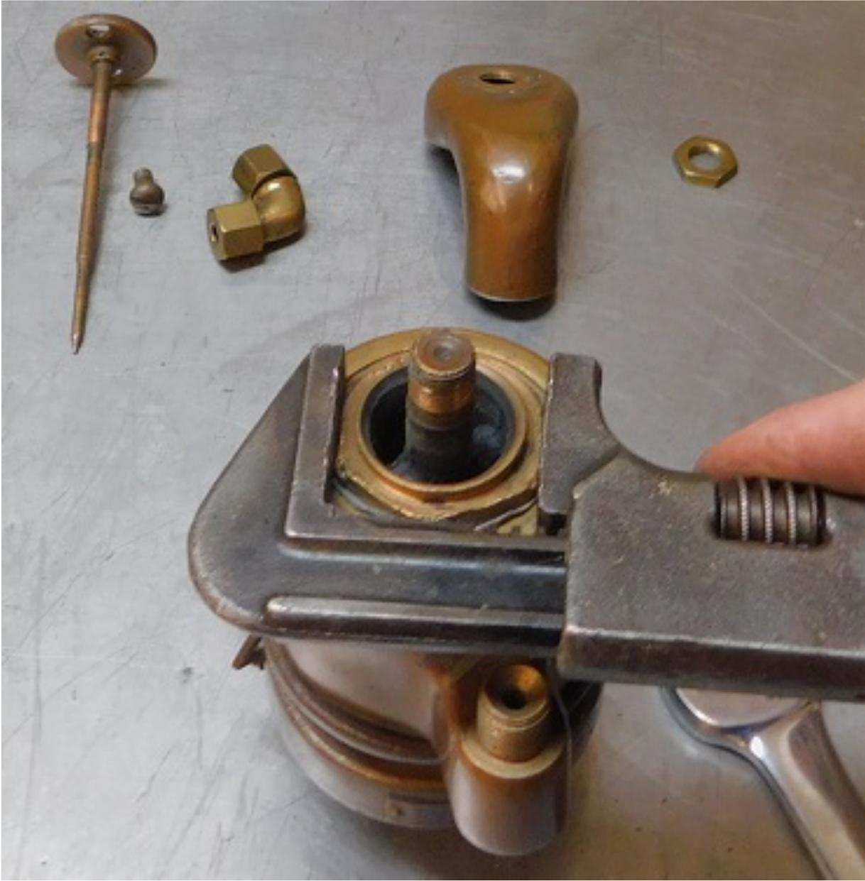
Das Entfernen der Kappe ermöglicht den Zugriff auf das Schwimmerscharnier und das Kraftstoffeinlassventil.
