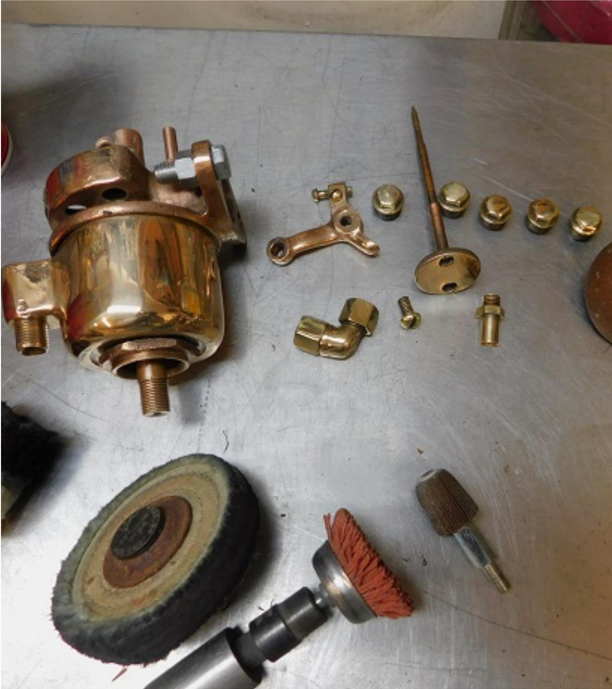
Nachdem alles gereinigt und poliert ist, können wir mit dem Zusammenbau beginnen. Eine Schraube und eine Mutter im Ansaugflansch ermöglichen es, den hübschen Vergaser in den Schraubstock einzuspannen, ohne Kerben und Kratzer zu verursachen. Der Drosselklappenstift ist an einem Ende leicht konisch geschliffen, damit er sich leichter einbauen lässt.
