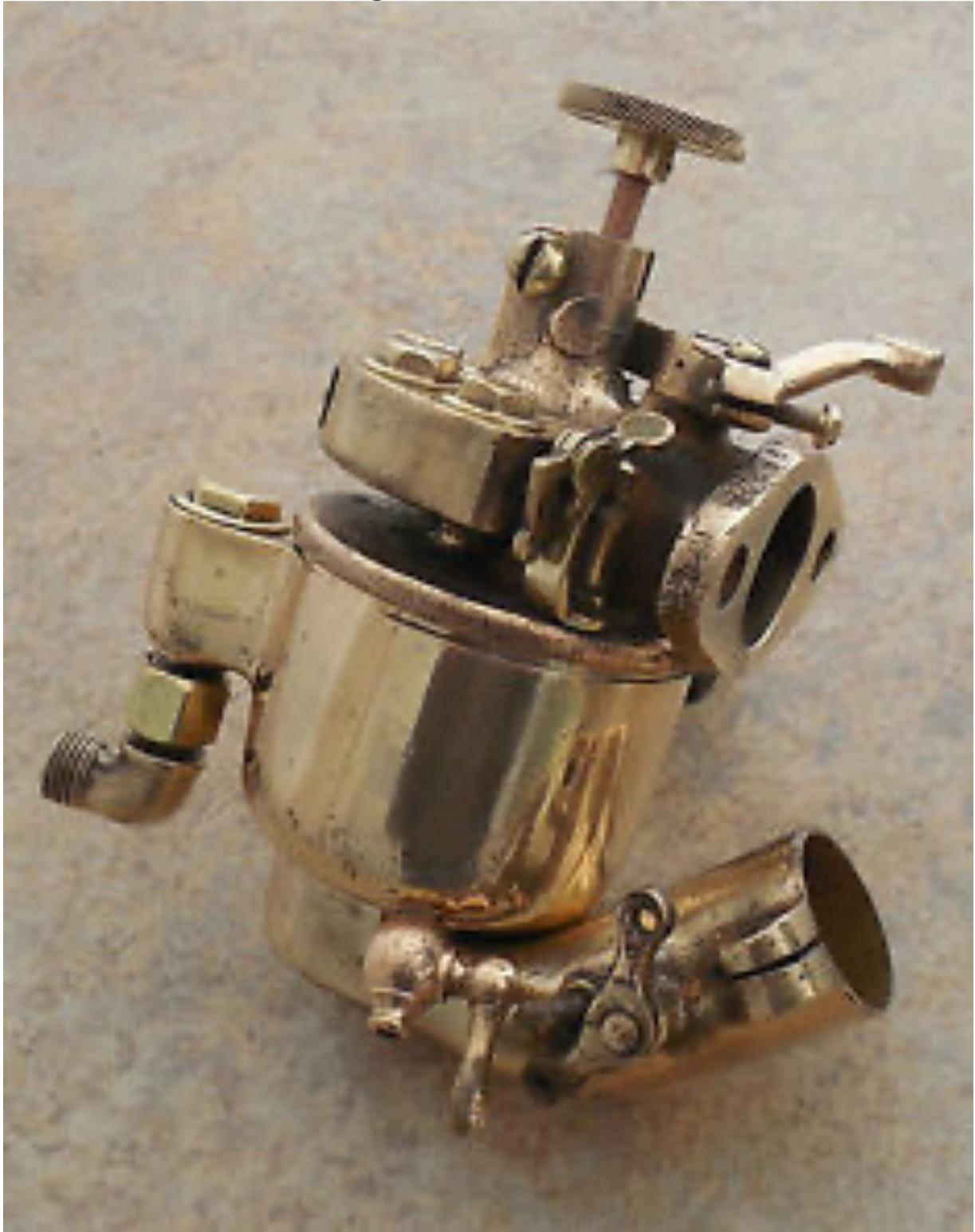
Der Kingston 5 Ball-Vergaser von 1910 bis 1911 ist genau derselbe wie die früheren Versionen, mit der Ausnahme, dass ein Choke hinzugefügt wurde und das Lufthorn jetzt in einem Winkel von 45 Grad steht. Reparatur und Wartung sind genau wie bei der frühen Version.
