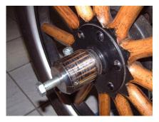
Die Demontage der Hinterräder erfolgt mit einem Radabzieher. Hierbei ist darauf achten, dass der Abzieher vollständig aufgeschraubt ist und die Arretierung, welche auf der linken Seite zu sehen ist,
