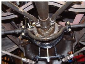
Nach dem Zusammenbau des Equalizers wird dieser an der quer liegenden Bremsstange befestigt. Hier kommen die Stoppmuttern zum Einsatz, da dieses Gestänge nicht fest angezogen wird, sondern geradeso ohne Spiel sich leicht bewegen lässt.
