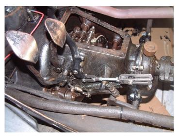
Jetzt kann man sich an den Ausbau des Bremspedals machen. Hierzu wird der Inspektionsdeckel des Getriebedeckels entfernt. Mit Draht sichert man das Band und rundherum sollte man mit Lappen alle Öffnungen verschließen. Es soll schon vorgekommen sein, dass eine Mutter oder Unterlegscheibe sich nach unten
