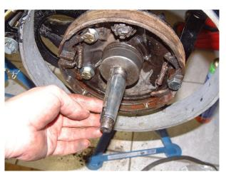
Hier ist das Shim genannte Abstandsblech. Es wird einfach auf die Achse aufgeschoben und
