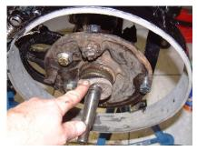
Bevor das Rad moniert wird sollte man die Radlagerabdeckung entfernen, das Lager optisch zu prüfen und etwas Lagerfett aufbringen. Ein neuer Dichtfilz und eine neue Abdeckkappe schliessen diese Kontrolle ab.
