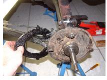
Die Klammern sind für die beiden Fahrzeugseiten unterschiedlich. Es muss jeweils diejenige verwendet werden, welche in der oberen Nase ein Loch für die Befestigung der Feder hat.
