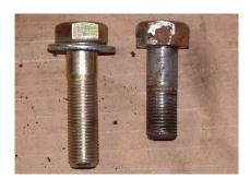
Diese beiden Schrauben werden durch neue ersetzt, welche um die Stärke der Klammer länger sind. Auf diesem Bild sieht man das deutlich.
