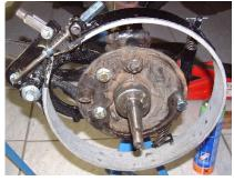
Die rechte Schraube wird ebenfalls ersetzt und die Halter werden entsprechend der Abbildung montiert. Der Halter mit dem kürzeren Ende und der etwas stärkeren Biegung muss als erstes auf die Schraube und nach unten weisen.
