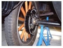
So sollte es nach Montage des Rades aussehen. Im Eifer des Gefechtes, den Sicherungssplint vor der Radmutter nicht vergessen!
