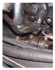
Das Pedal lässt sich zwar ohne den Deckel des Bendix zu entfernen ausbauen, doch der Einbau ist nur ohne diesen Deckel möglich.
