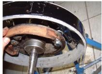
Nun muss die rechte Schraube genau eingestellt werden. Der Bremssattel der Notbremse muss ohne Spiel an der Radplatte anliegen. Jetzt wird die Mutter dieser Schraube fest angezogen.
